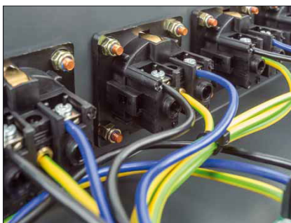
Die Verdrahtung des Gerätes erfolgt mit Litzenleitungen mit 1,5 Quadratmillimetern Querschnitt
